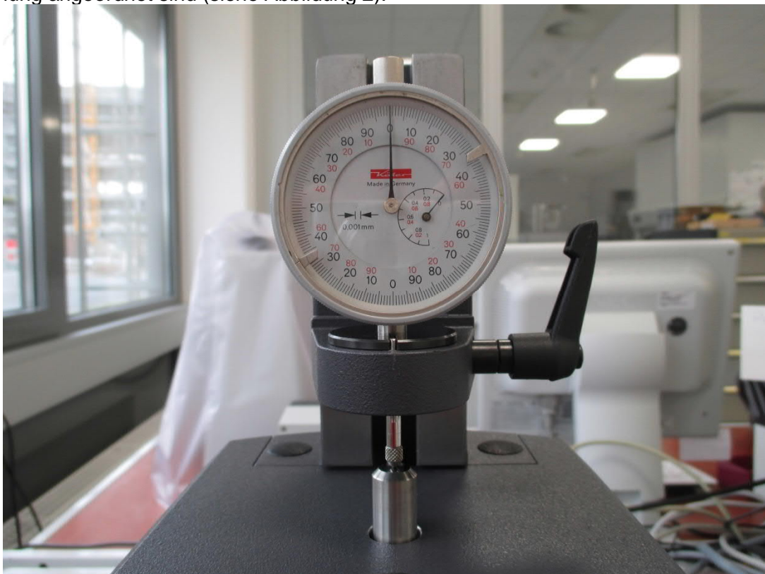
Abbildung 2: Aufbau des Messuhrenprüfstandes
